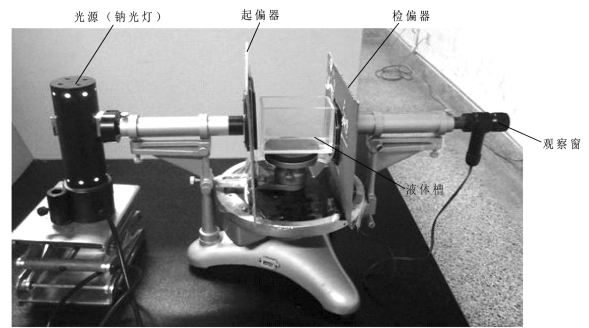
图 1 直读式分光计旋光仪装置实物图(侧视图)
