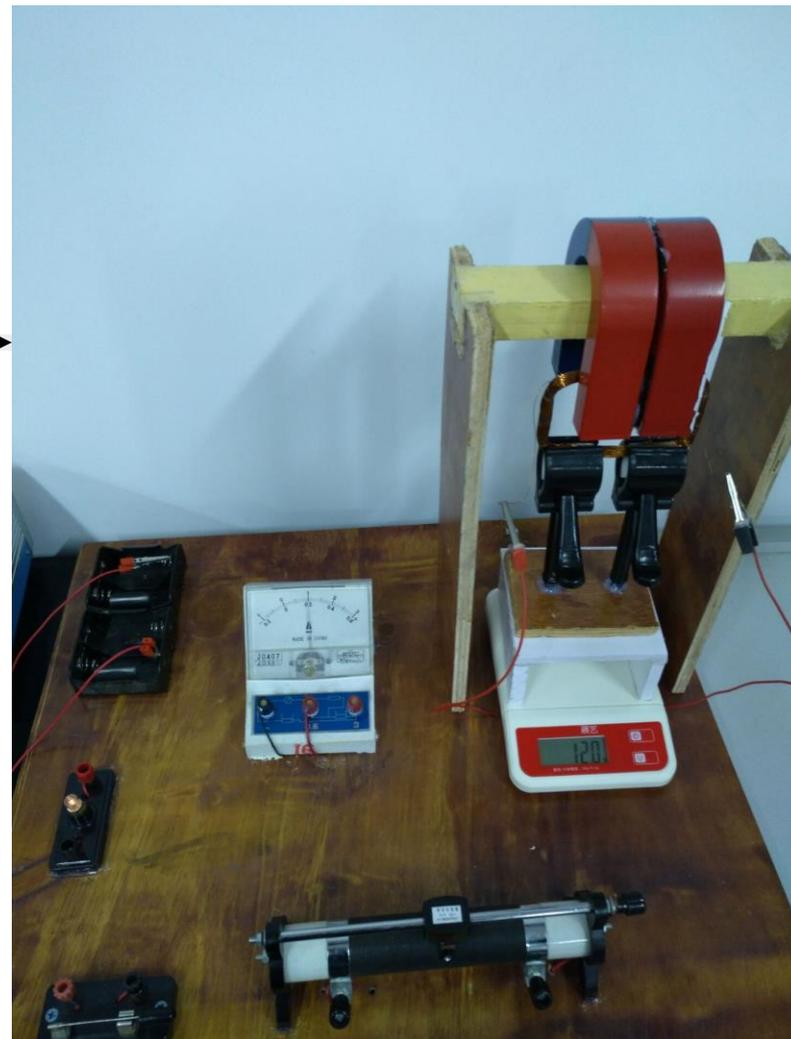
**定量探究安培力与导线长度的关系**
